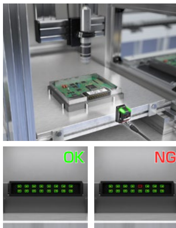
Kiểm tra gãy chốt đầu nổi
